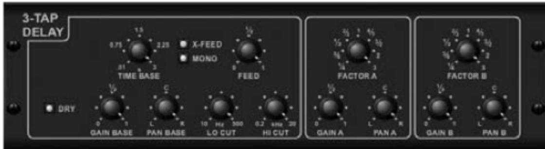
Manchmal als 3-Tap-Verzögerung bezeichnet, bietet das Triple Delay drei Verzögerungsstufen mit unabhängigen Frequenz-, Gain- und Pan-Reglern. Erstellen Sie mit dem Triple Delay zeitbasierte Echo-Effekte, um die Stereotrennung zu verbessern.
