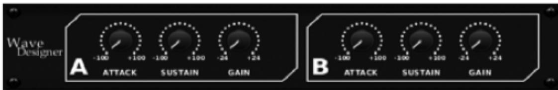
Wave Designer ist ein leistungsstarkes Tool zum Anpassen von Signaltransienten und -dynamiken wie Attack und Sustain. Verwenden Sie diese Option, um eine Snare-Drum wirklich zum „Knacken“ zu bringen oder Lautstärke-Inkonsistenzen von Slap-Bass-Tracks auszugleichen. (Inspiriert vom SPL Transient Designer)
