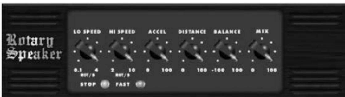
Rotary Speaker emuliert den Klang eines Leslie-Rotationslautsprechers. Der Rotary Speaker des X32 bietet mehr Flexibilität als sein elektromechanisches Gegenstück und kann mit einer Vielzahl von Instrumenten und sogar Gesang verwendet werden, um einen wirbelnden, psychedelischen Effekt zu erzeugen.
