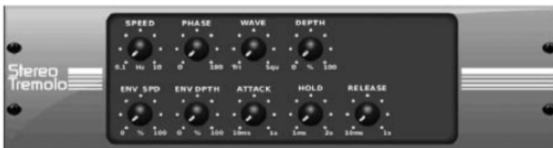
Stereo-Tremolo erzeugt einen Lautstärkewechsel nach oben und unten mit einem konstanten und gleichmäßigen Tempo, genau wie die Gitarrenverstärker von gestern. Verwenden Sie das Stereo-Tremolo von X32, um einer Gesangs- oder Instrumentenspur eine einzigartige Surf-Musik-Textur hinzuzufügen.
