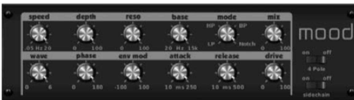
Das StimmungsfILTER verwendet einen LFO-Generator und einen automatischen Hüllkurvengenerator zur Steuerung eines VCF (spannungsgesteuerten Filters) sowie eine Seitenkettenfunktion, bei der das Signal von Kanal B die Hüllkurve von Kanal A steuert. Mood Filter kann verwendet werden, um den natürlichen Klang von akustischen Instrumenten zu emulieren. (Inspiriert vom MiniMoog)
