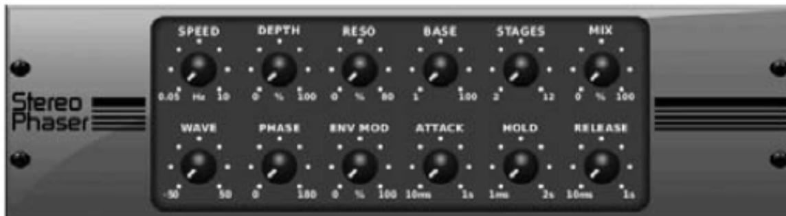
Ein Stereo-Phaser oder Phasenschieber wendet mehrere STUFEN modulierter Filter auf das Eingangssignal an, um eine „Kerbe“ im Frequenzgang zu erzeugen, und wendet dann einen MIX mit dem Original für einen „Wirbeleffekt“ an. Verwenden Sie den Stereo-Phaser von X32, um Vokal- oder Instrumentenspuren einen „beabstandeten“ Sound hinzuzufügen.
