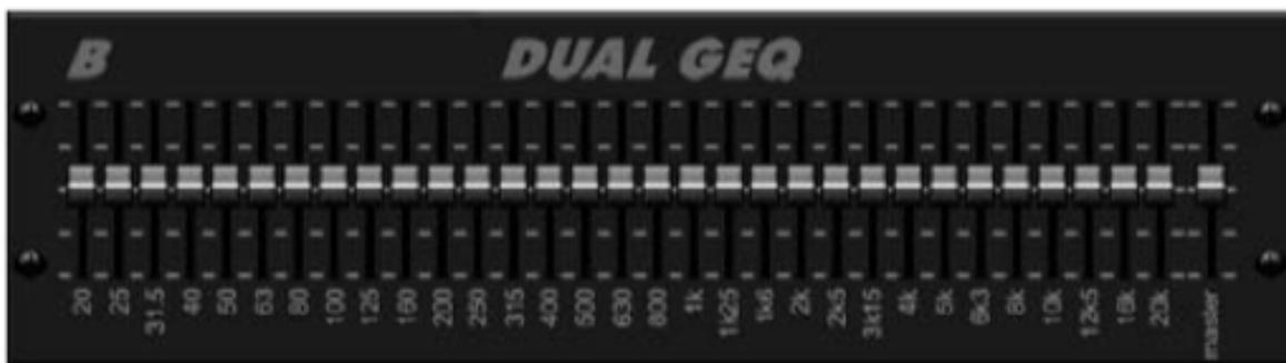
Dies sind Standard-Grafik-Equalizer, die 31 Einstellbänder zwischen 20 Hz und 20 kHz bieten. Ein Hauptlautstärkereger gleicht die durch den Ausgleich verursachten Lautstärkeveränderungen aus. Für jedes Band ist eine maximale Anhebung oder Absenkung von 15 dB verfügbar.
